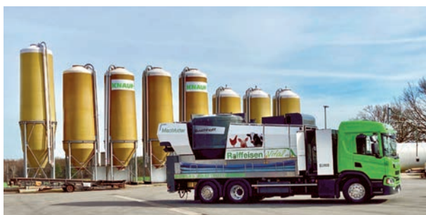
FAHRBARE MAHL- UND MISCHANLAGE
